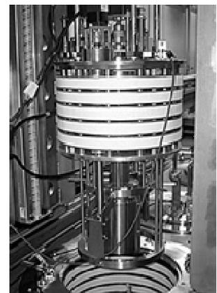
図2 電解精製装置
