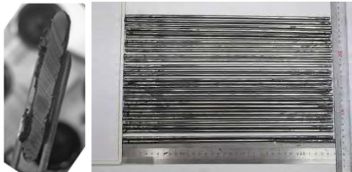
図3 (左)陰極回収物を塩蒸留して得られたUインゴットの断面
