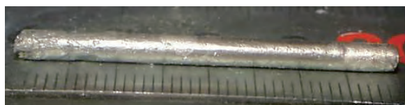
図1 射出鋳造した U-Pu-Zr-1.4Am スラグ
