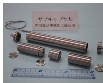
図5 内部部品機械加工確認用サブキャプセル
