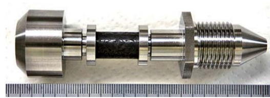
図 2 内圧負荷用の両端栓に取り付けた試験片外管 (組み立て後)
