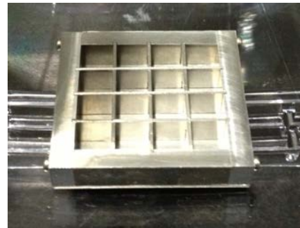
開発した実環境模擬空間 (ECC) および水素捕集装置のプロトタイプ
