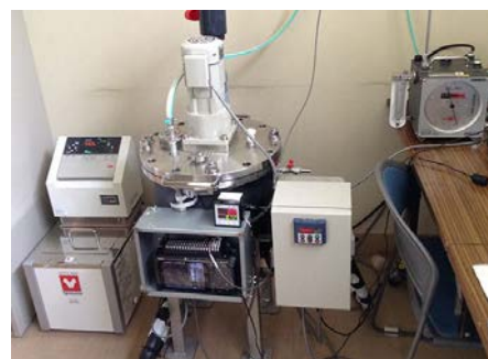
図 4. 固体メタン発酵槽
