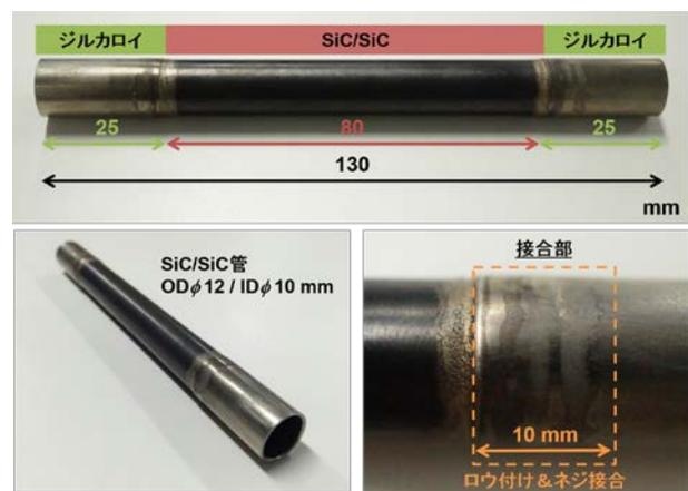
図 3 照射試験用 SiC/SiC 被覆管セグメントの外観
