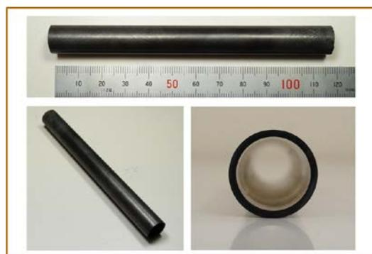
図1 外径 12mm、肉厚 1mm、長さ 100mm 以上の SiC/SiC 被覆管外観
