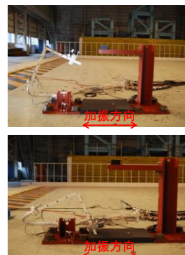
図3 荷重モード毎の破損メカニズム解明 — 過大地震荷重
