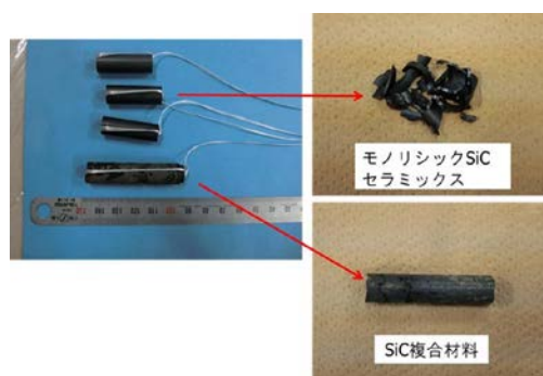
図 14 熱衝撃試験前後の外観
