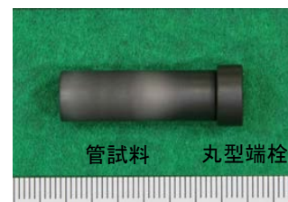
図 13 接合試験（管一端栓）
