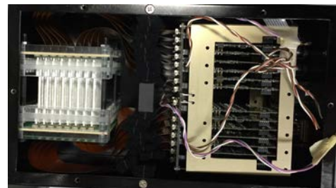
図7 高線量率版ガンマイメージャ写真。左部白い棒が1mm角の棒状シンチレータ。
