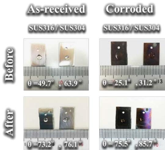
図 8 超臨界暴露前後およびイオン照射前後の SUS 材の濡れ性
