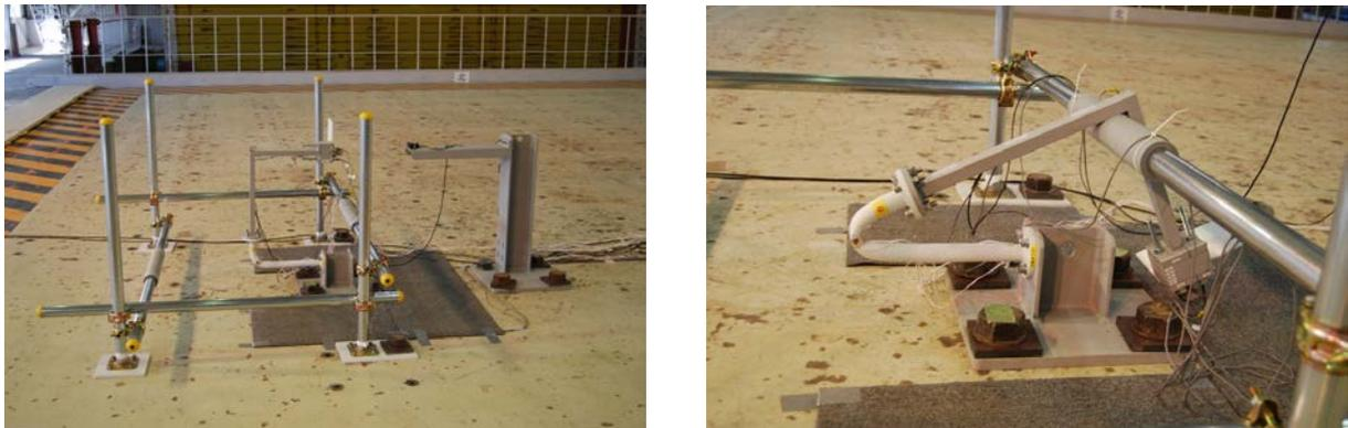
図5 配管エルボの振動破壊試験体と崩壊が観察された例
