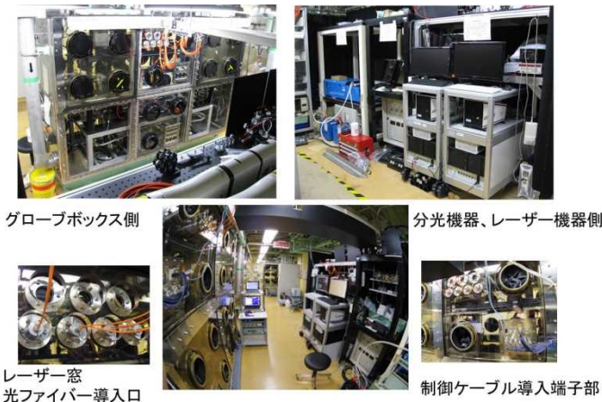
図2 レーザー遠隔分析専用グローブボックスの整備
