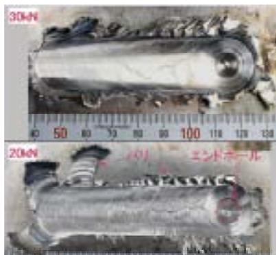
ナトリウム中 FSW 後の補修部外観 FSW 補修した試験板断面
