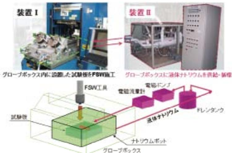
ナトリウム中 FSW に使用した試験装置
