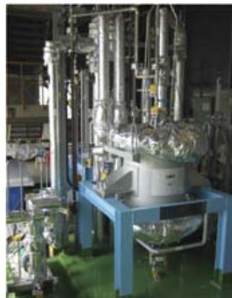
図3 遠隔操作に対応した工学規模分離塔システム
