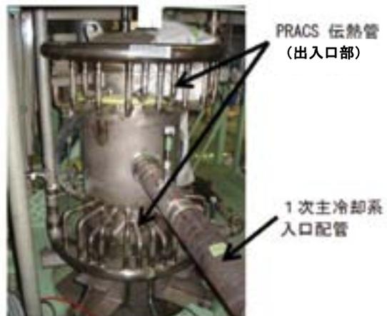
ナトリウム試験装置 (試験部外観)
