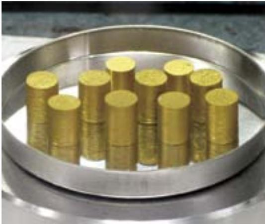
図1 TiN を母材とした燃料ペレットの外観写真
