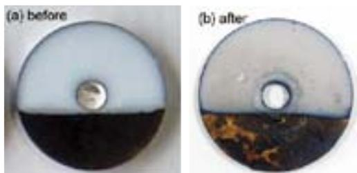
↑図2 650°CのLBE中で100時間までの回転腐食試験前後のNMCP被覆（試験片白色部）。被覆部では腐食は見られない。
