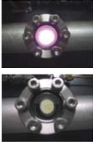
図 1 プラズマ容器ビューポートから見たヘリウムプラズマ(上)と析出した炭素(下)
