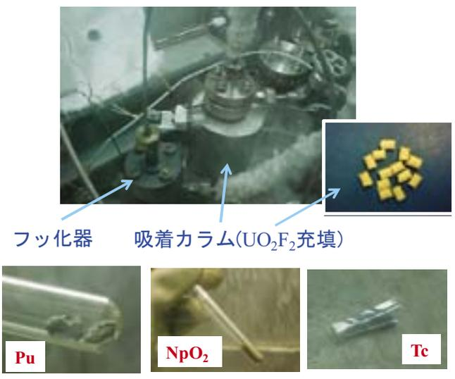
図3 Pu, Np, Tc 試験装置(5g 規模)
