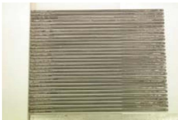
図3 本研究で製作した金属燃料ピン (U-10wt.%Zr合金ロッド：約4.2kg)
