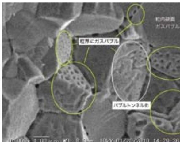
MAから生成したヘリウムが集まって結晶粒界に気泡を形成している電子顕微鏡写真<sup>1)</sup>
