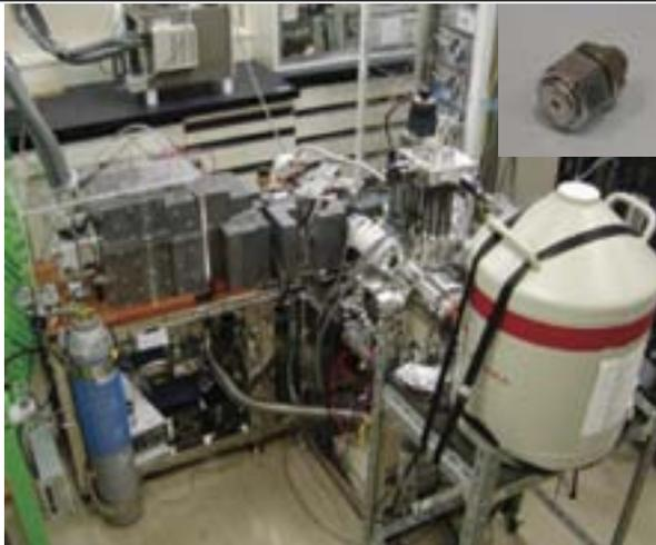
開発した陽電子マイクロビームと小型線源（右上）の外観写真<sup>4)</sup>。
