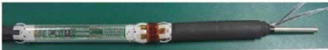
新プローブのECT(渦電流探傷)部分の写真
