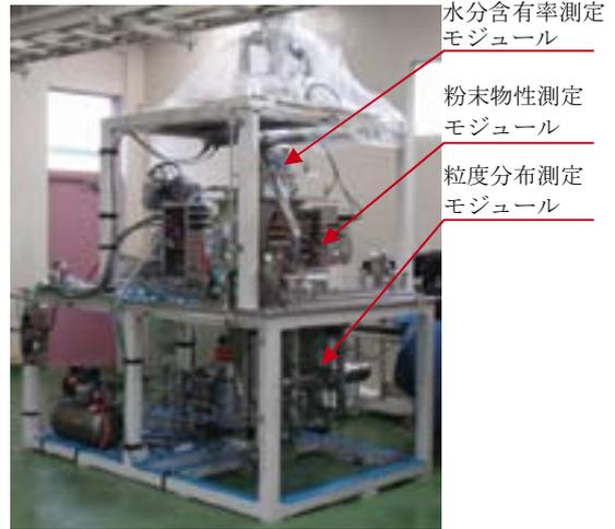
図 2. インライン式粉末分析装置のモジュール化試験機
