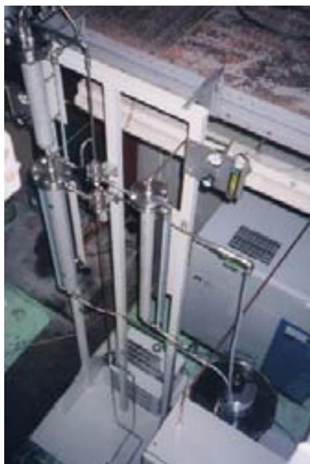
図1 気液混合流体の熱流動特性の解明に用いた実験装置（左：高圧ループ・20気圧までの高圧力条件を含めて検証実験を実施しました。右：低圧ループ・水と空気を用いた実験で、気液混合流体の基礎的な流動特性を詳細に調べました。）
