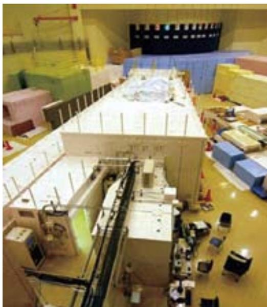
図1 J-PARC 物質・生命科学実験施設に設置した中性子核反応測定装置
