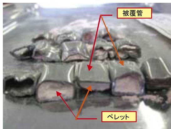
ラップ管を取外した後、燃料ピンが燃料集合体に固定されている部分を切断砥石で切断している様子です。
