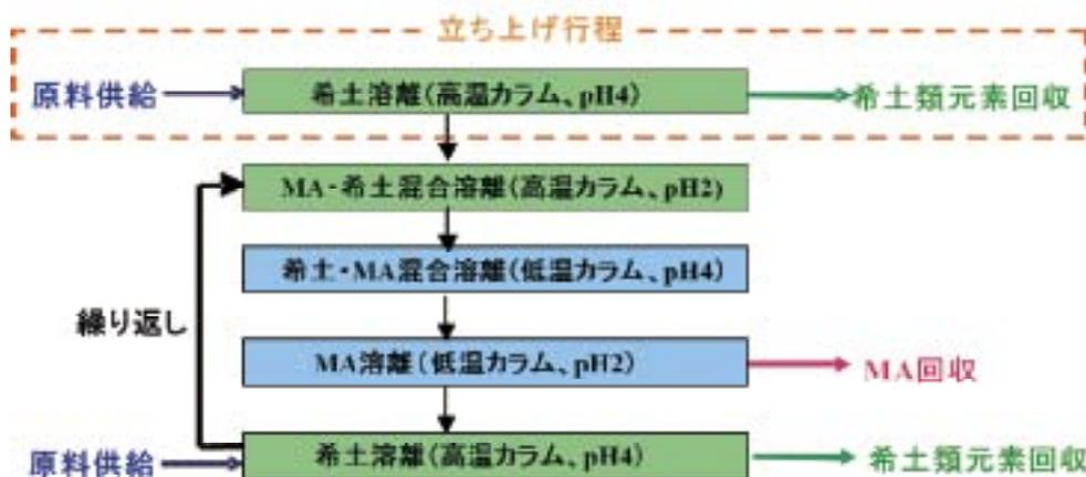
図2 低温・高温2塔プロセスによる MA・希土類元素分離
