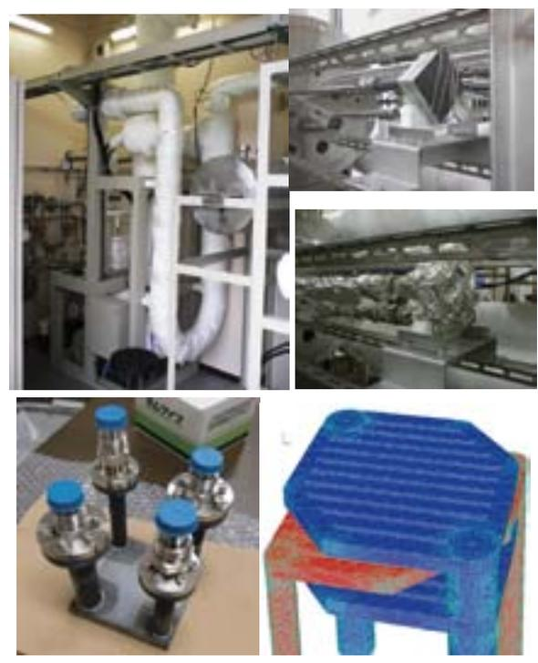
セラミック複合材による熱交換器構造の製作手順。複雑な流路を板材の多層接合で構成しました。
