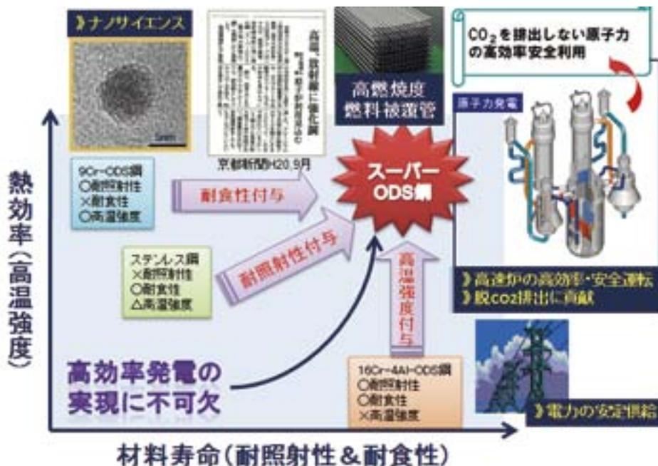
図2：開発したスーパーODS 鋼の位置づけ
