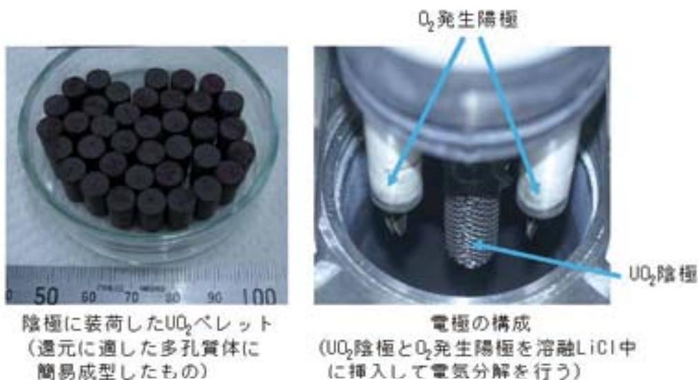
図1 電解還元装置とUO<sub>2</sub>ペレット
