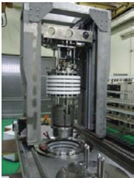
図2 本研究開発で設計製作した電解精製装置
