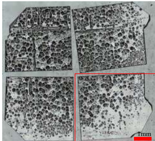
9mm角ダイヤモンド単結晶基板上に合成し、レーザー切断した後の試料。右の測定例は赤枠部分の試料から製作した検出素子による。レーザー顕微鏡写真10倍
