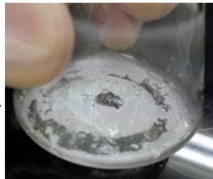
TiO<sub>2</sub>沈殿生成
