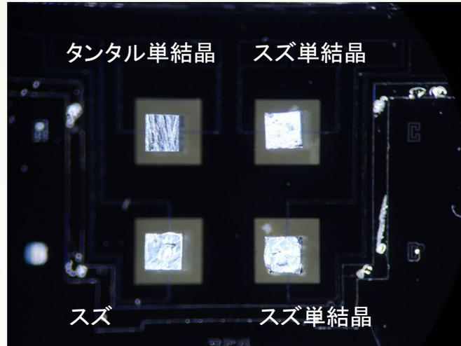
スズ(Sn)単結晶の吸収体を搭載したTES検出素子(左)、スズ(Sn)単結晶およびタンタル(Ta)単結晶の吸収体を実装したTESアレイ検出素子の写真(右)
