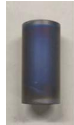
酸化試験後 試験片
