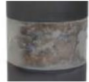
酸化試験後 試験片
